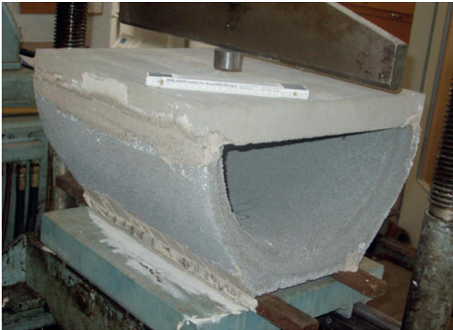
Abb. 12: Bestimmung der Bruchlast von Halbschalen und Abdeckplatten
