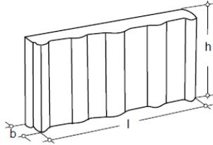
Dränsteine aus haufwerksporigem Beton werden zu einer Dränwand aufgebaut um erdberührte Bauwerke vor nichtdrückendem Wasser zu schützen (DIN 4095). <sup>1)</sup>
