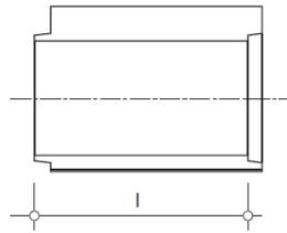
Bei dem vollporösen Betonfilterrohr Dränit besteht der gesamte Rohrumfang aus haufwerksporigen Beton.
